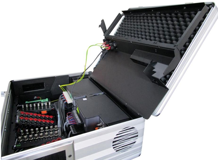
6. Lösen und entfernen Sie die Schraube, mit der die Modulhalterung befestigt ist. Die Schraube befindet sich zwischen den Modulen im Kofferboden.
